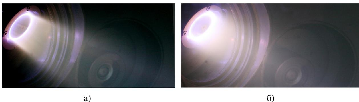
Рис. 5. Фотографии разряда ионного источника УАС-40 при работе в нормальном ускорительном (а) и магнетронном (б) режимах
