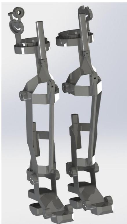
**Рис. 5.** Предварительный вариант исполнительного механизма экзоскелета нижних конечностей капсульного типа
