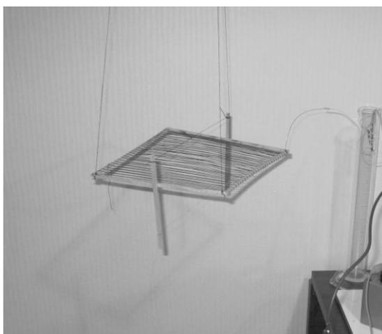
Рис. 2. Модель, использовавшаяся в экспериментах по определению зависимости силы тяги от напряжения.
