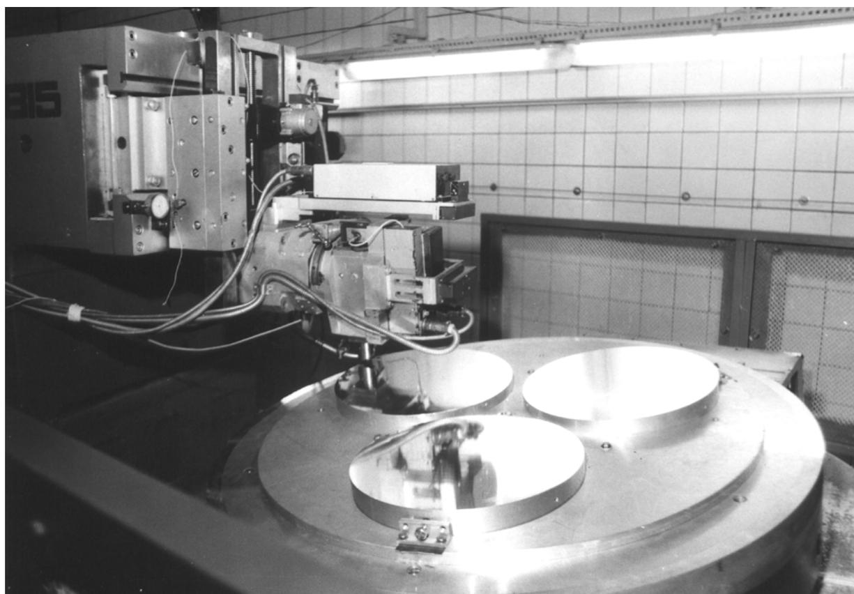
Рис. 2: Алмазное точение внеосевых параболоидов диаметром 406 мм каждый
