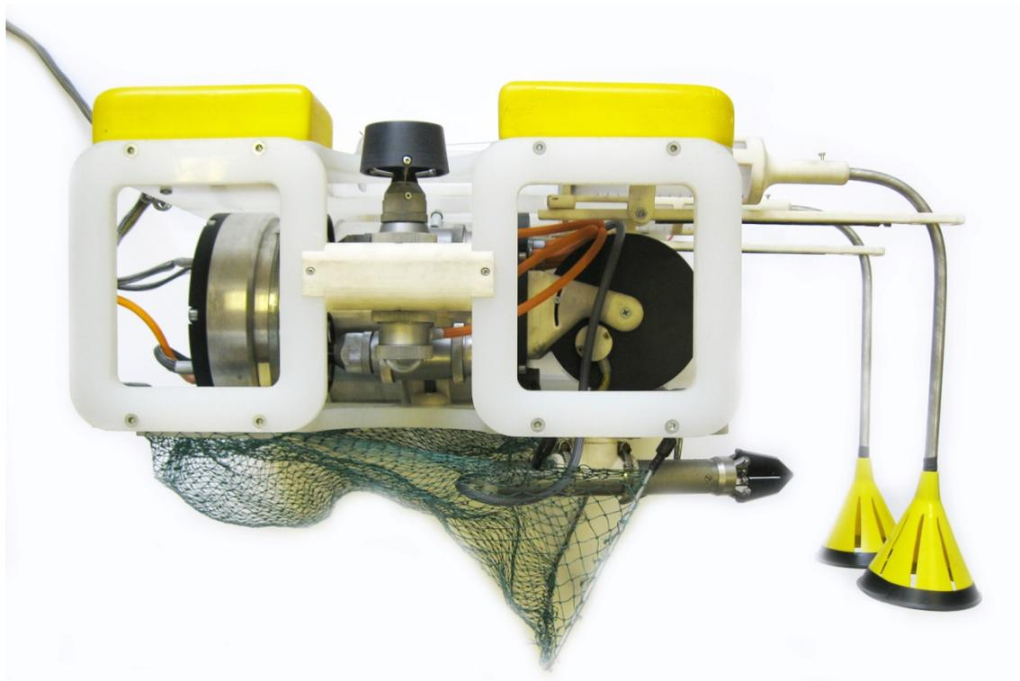
Фото 4. Гидробот «АКВАТОР II» в состоянии готовности к работе на донном полигоне опытового бассейна NBL NASA
